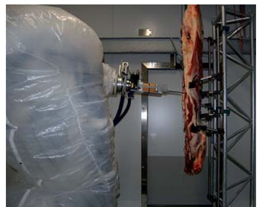
Prototype de mise en quartier robotique des demi-carcasses de gros bovins © ADIV
